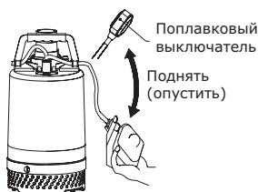
Рис. 14 Проверка направления вращения насоса с поплавковым выключателем
